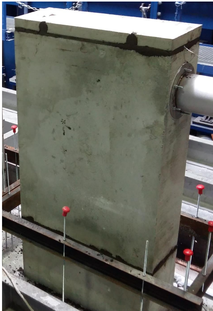
Photo du conduit mis en œuvre à l'extérieur du four
