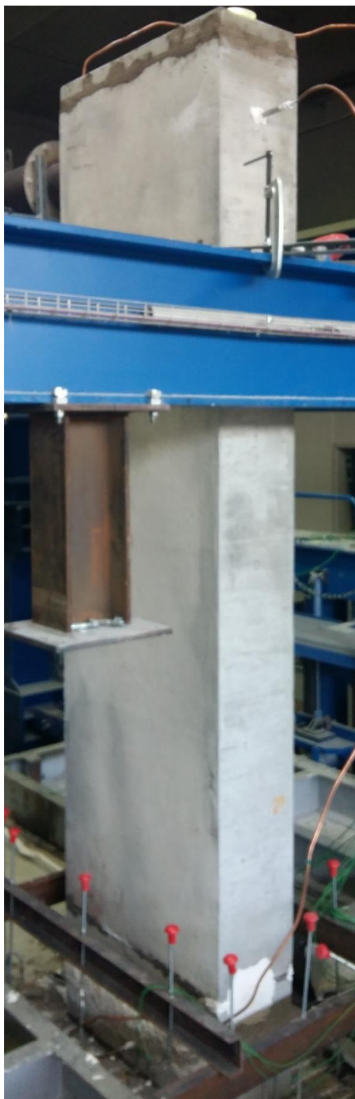
Photo de la partie du conduit non exposée au feu après essai
