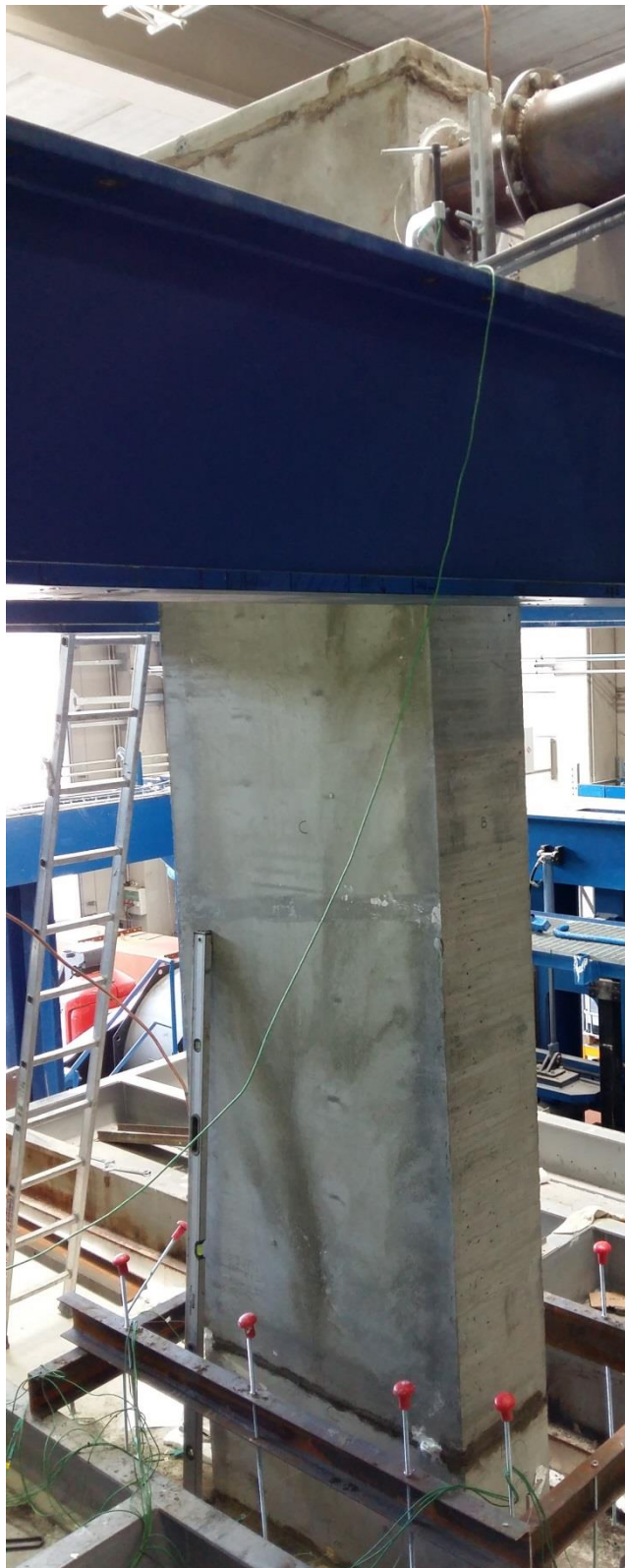
Photo de la partie du conduit non exposée au feu avant essai
