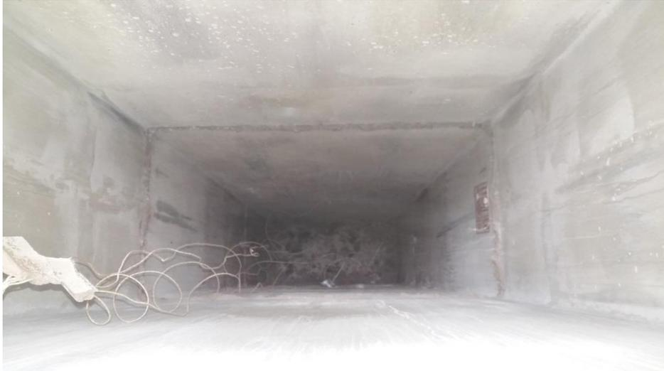
Photo de la paroi interne du conduit après essai et refroidissement
