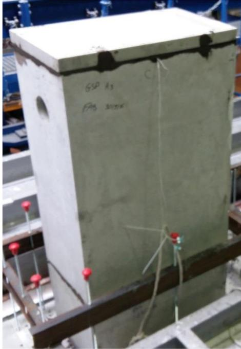
Photo du conduit monté à l'extérieur du four
