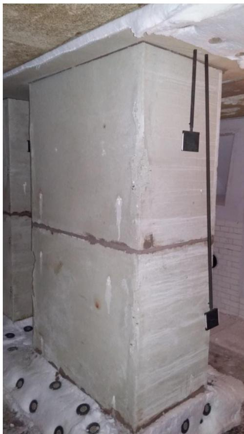
Photo de la paroi externe du conduit exposée au feu après essai et refroidissement
