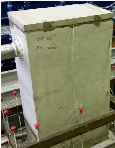
Photo de la paroi externe du conduit non exposée au feu avant essai
