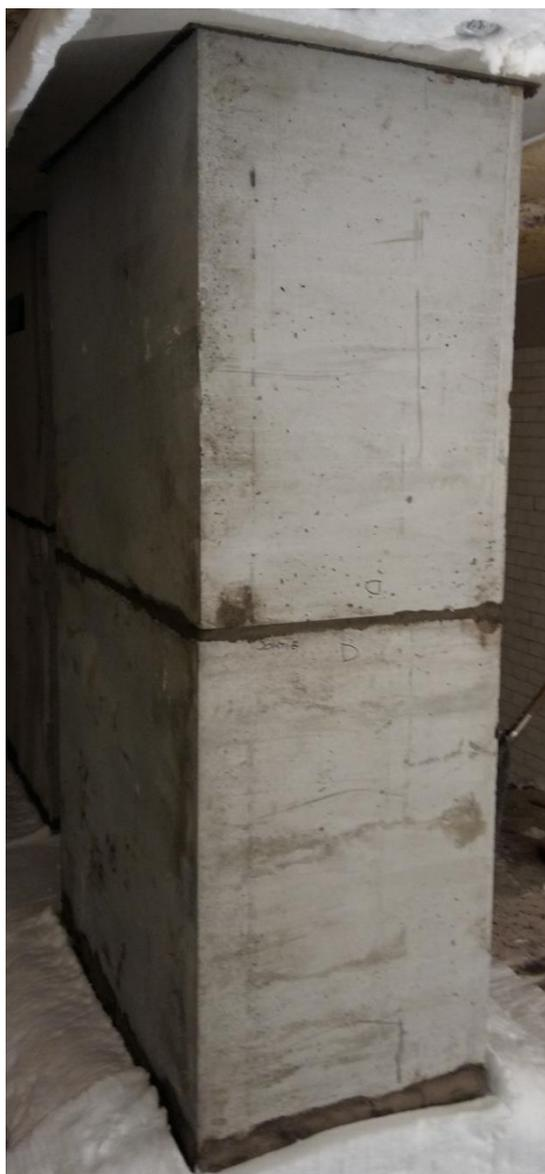
Photo du conduit monté à l'intérieur du four
